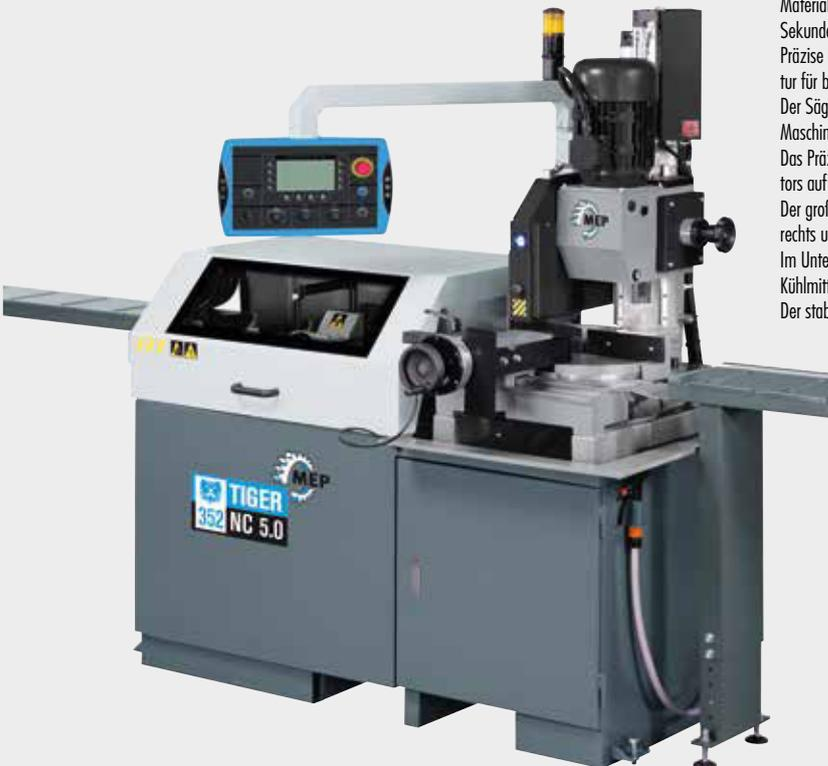
Windows CE basierte Steuerung mit großem 7" Touch-Screen und zusätzlichen um den Touch-Screen angeordneten Tasten für häufige Funktionen. (der Touch-Screen muß nur für Schnittprogrammierungen berührt werden)
