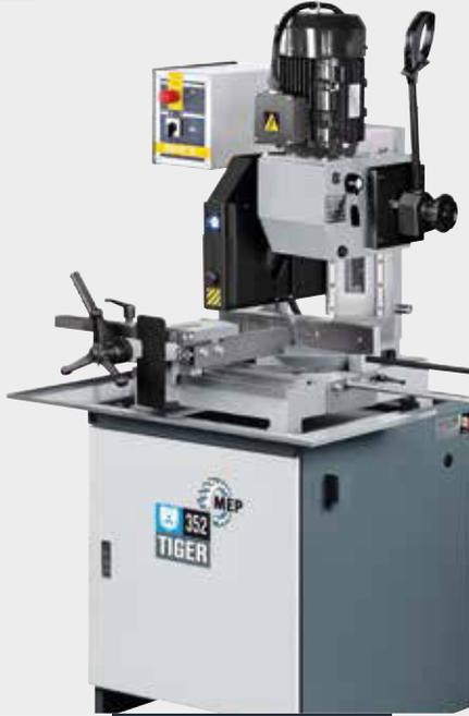
Der Sägekopfabstieg erfolgt auf doppelten Kugelumlauf-Linearführungen. Maschine verfügt über 4 Blattdrehzahlen um auf allen Metallen eingesetzt werden zu können. Das Präzisions-Getriebe mit doppeltem Rädersatz sorgt für die perfekte Kraftübertragung des leistungsstarken Antriebsmotors auf die Sägewelle.
